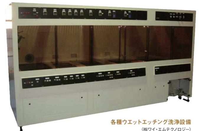
各種ウエットエッチング洗浄設備
